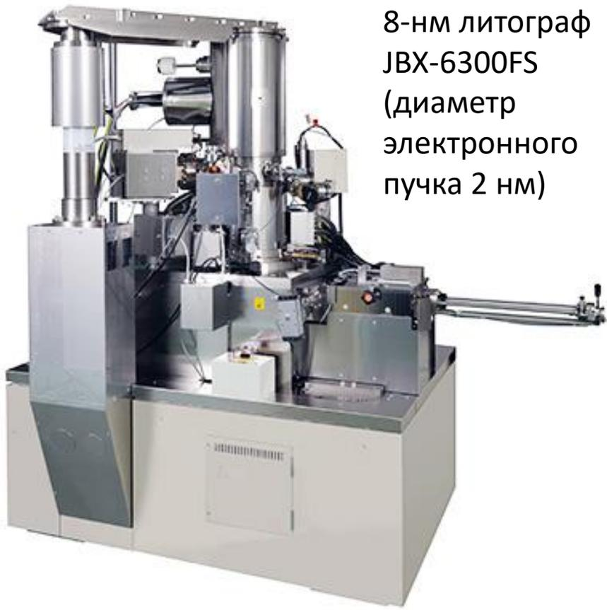
Установка для электронно-лучевой литографии включает вакуумируемую колонну с источником электронов, системой ускоряющих электродов, магнитными линзами и системой сканирования электронного луча по поверхности экспонируемой подложки.
