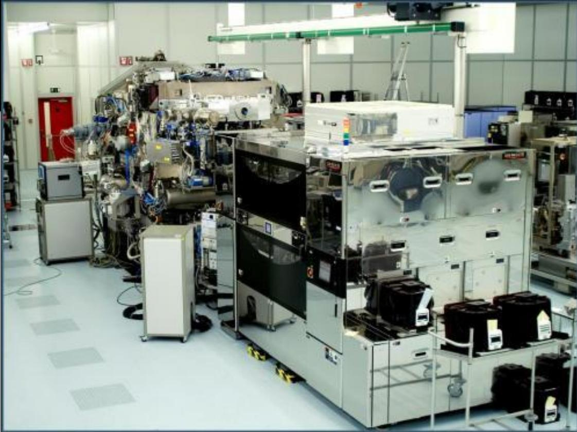
Данный вид литографии имеет максимальную производительность и удовлетворяет требованиям массового производства. Однако минимальные размеры элементов ограничены длиной волны используемого излучения и соответствующей оптикой.
