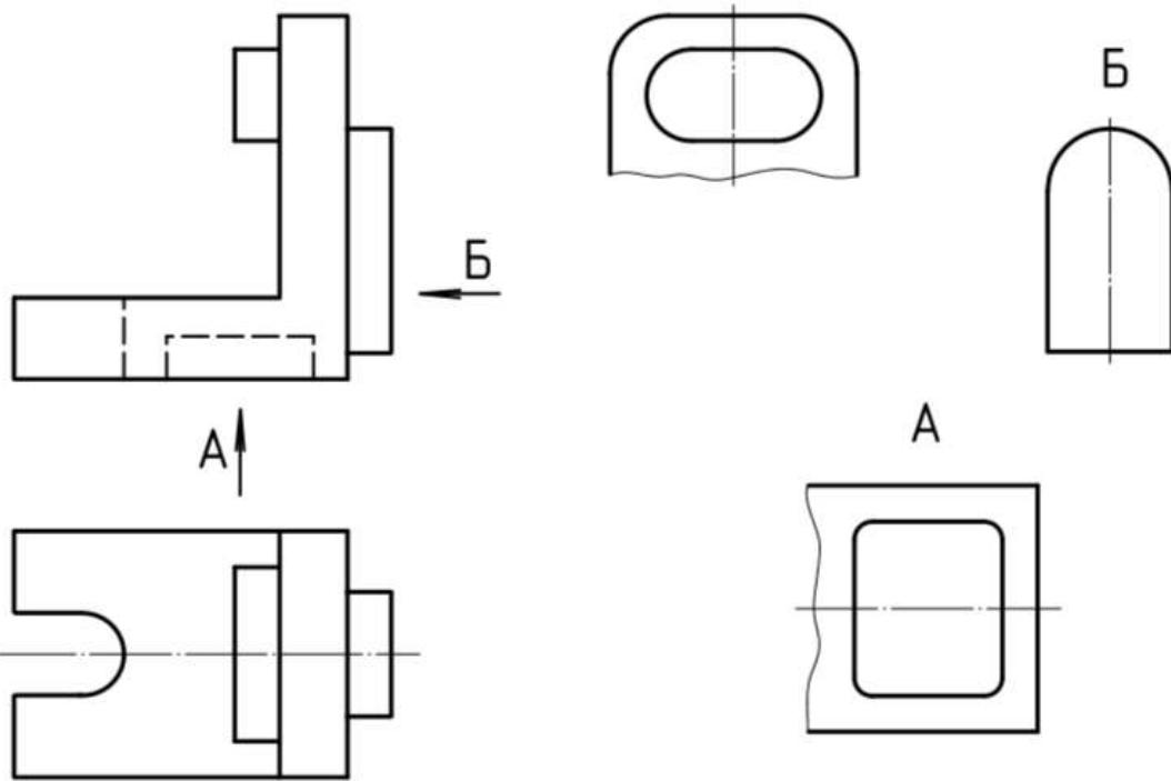
Местный вид - изображение отдельного ограниченного места поверхности предмета. Местный вид оформляют на чертеже подобно дополнительному с учетом наличия или отсутствия его проекционной связи с соответствующим изображением. Местный вид может быть ограничен линией обрыва.
