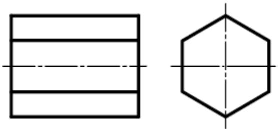
Количество изображений и размеров на чертеже должно быть минимальным, но достаточным для полного раскрытия внешних и внутренних форм детали и обеспечения обратимости чертежа. Допускается давать количество изображений больше минимального, если это существенно упрощает чтение чертежа.
