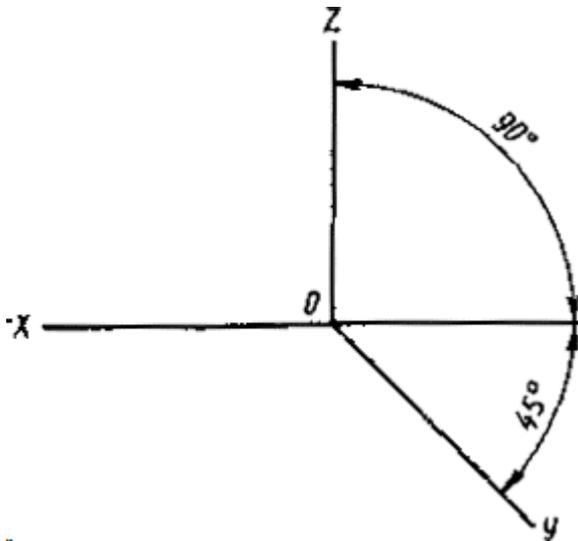
Горизонтальная изометрическая проекция ( $u = v = w = 1$ )
