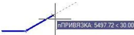
С помощью режима полярного отслеживания можно выполнять геометрические построения с любым выбранным шагом. К примеру, если выбран угол  $30^\circ$ , то после задания первой точки отрезка будут отображаться линии отслеживания в тех случаях, когда направление от этой точки до перекрестия курсора будет кратным  $30^\circ$ , т.е.  $60^\circ$ ,  $90^\circ$ ,  $120^\circ$  и так далее.
