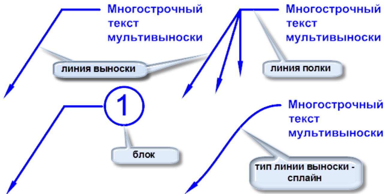
Визуальное представление мультивыноски, как и другие ее параметры, можно редактировать при ее создании или на функциональной панели **Свойства**. Например, можно отображать или скрывать полку, линии выноски, изменять внешний вид стрелки, создавать рамку вокруг текста, менять точку присоединения блока и т.д.
