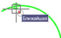
3. Переместить курсор ближе к конечной точке дуги, при отображении маркера привязки щёлкнуть левой кнопкой мыши для выбора конечной точки первой выносной линии размера:
