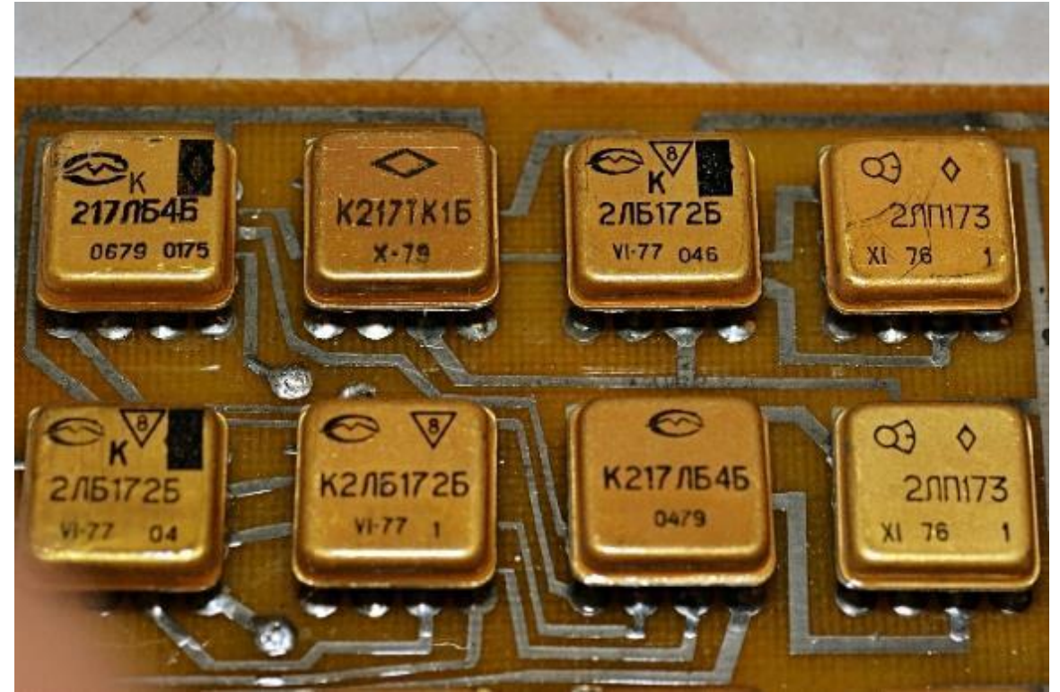
Микросхемы серии 217, выполненные на тонких пленках, 1970-е годы
